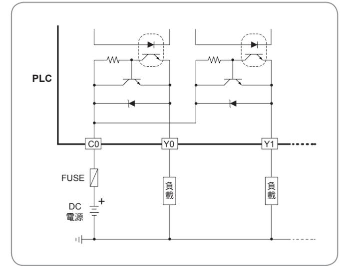
M4T 主機 Y0~Y7 電晶體 SINK 輸出接線
