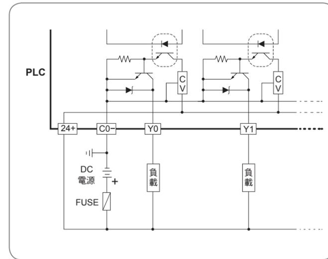
M4J 主機 Y0~Y7 電晶體 SOURCE 輸出接線
