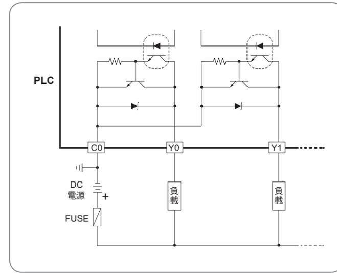
單端共點電晶體 SOURCE 輸出接線
